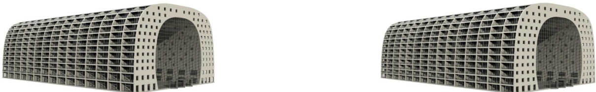
Figura 4.2 Esquerda: Market Hall gerado a partir do programa desenvolvido. Direita: Edifício gerado após a mudança da posição das lajes.
