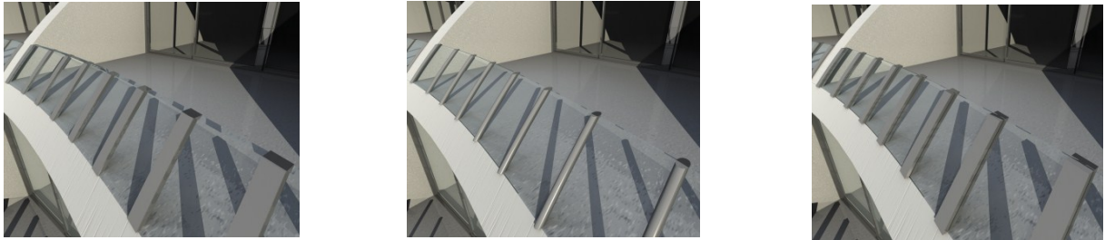
Figura 4.4 Mudando a secção dos prumos. Esquerda: rectangular. Centro: circular. Direita: perfil em forma de I.
