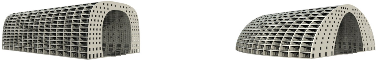
Figura 4.1 Esquerda: Market Hall dos MVRDV gerado a partir do programa desenvolvido. Direita: Um edifício diferente gerado mudando a forma global do edifício e a sua secção ao longo do eixo longitudinal.
